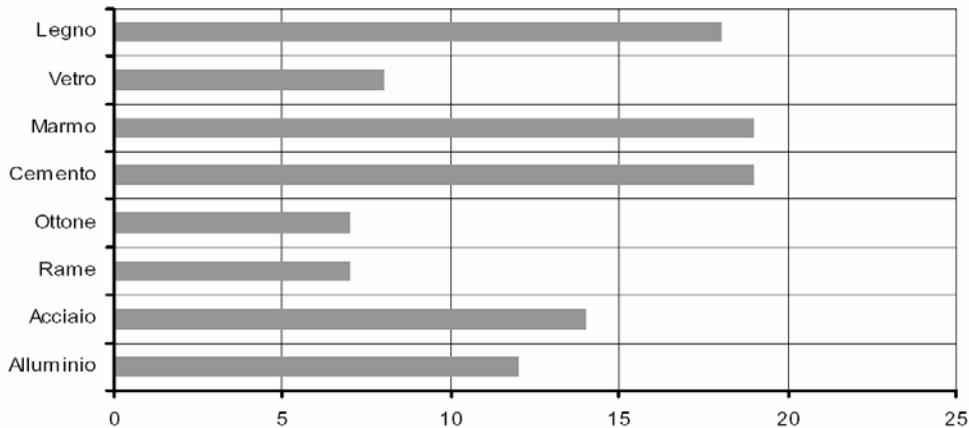
I test sono stati condotti alla temperatura di 20°C su giunture metallo-metallo tipiche dopo indurimento di 48 h a 20°C. Pre-trattamento effettuato mediante sabbatura e sgrassatura con acetone.
