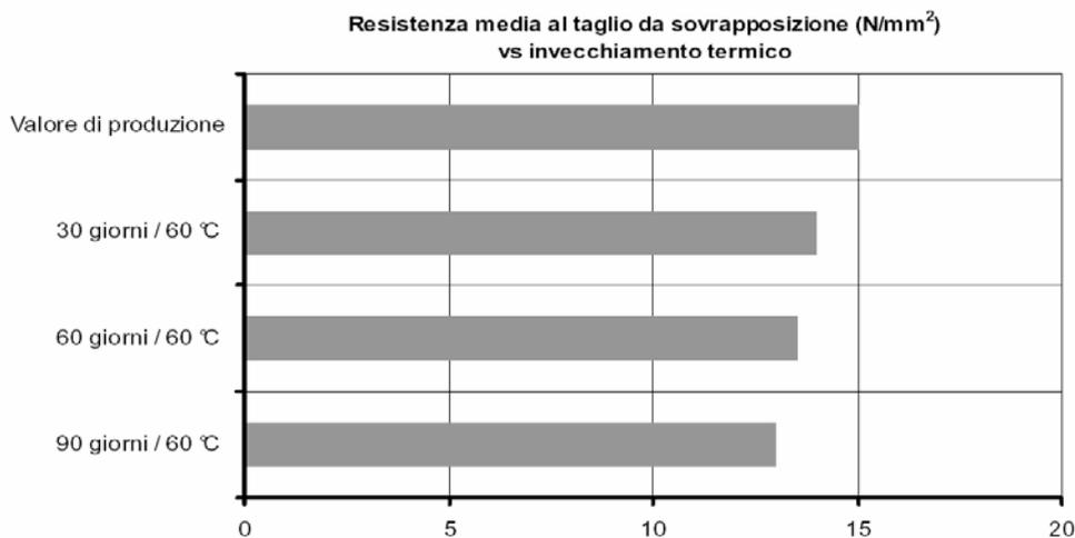
I test sono stati condotti alla temperatura di 20°C su giunture acciaio-acciaio tipiche dopo invecchiamento a 60°C.
