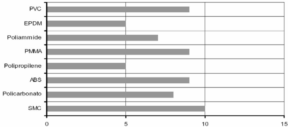
I test sono stati condotti alla temperatura di 20°C su giunture plastica-plastica tipiche dopo indurimento di 48 h a 20°C. Pre-trattamento effettuato con abrasione e sgrassatura con isopropanolo.
