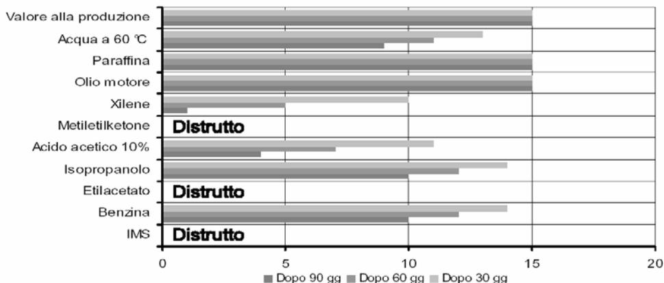
Ove non altrimenti indicato, i test sono stati condotti a 20°C dopo immersione per 30, 60 e 90 gg a 20°C su giuntura acciaio-acciaio tipica dopo indurimento di 48 h a 20°C.
